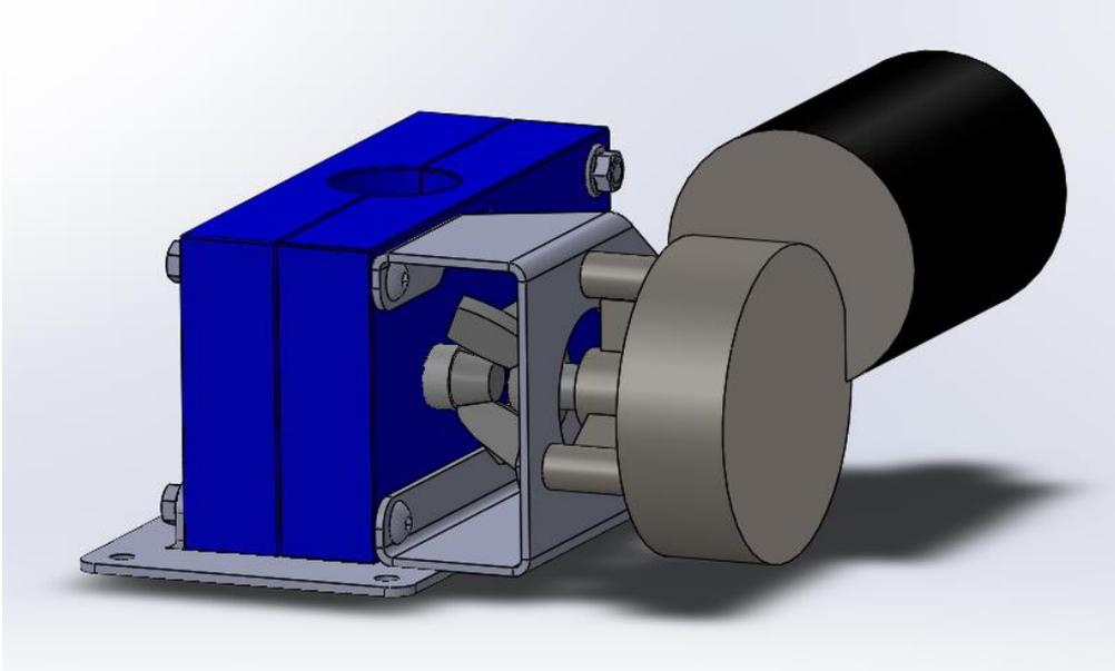
Die Flügelmutter gibt die Kraft des Motors an die Flügelschraube weiter. Die Walze dreht sich und wird nun angetrieben.
